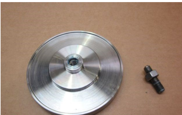
Step 23. Remove the 5/16" UNF stud and nut.
